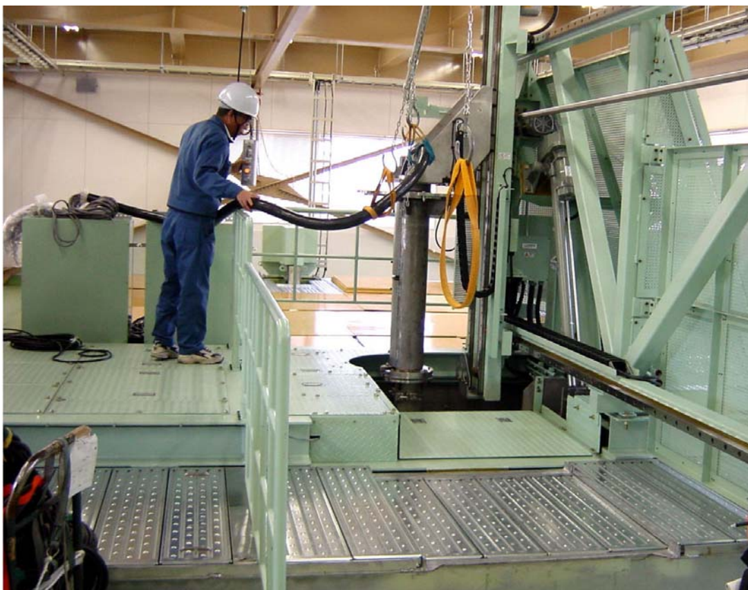
Foto 1: Tanque de agua más grande para los transductores de sonares scanning
